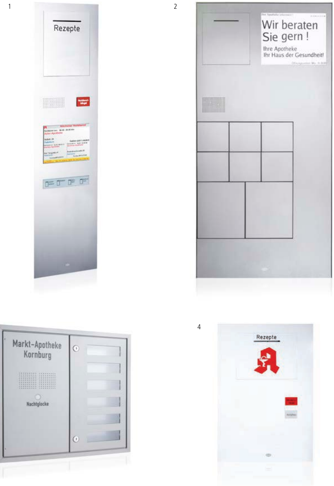
Abb. 1 Apotheken-Anlage für Türseitenteil-Montage mit Rezepteinwurf, Medikamentendurchreiche, Klingel für Notdienst, Sonder-Sprechfeld, elektronische Notdienst-Anzeige, farbig ausgelegte Eingravur. Abb. 2 Apotheken-Anlage für Türseitenteil-Montage mit Rezepteinwurf, Medikamentendurchreiche, elektronische Notdienstanzeige, Sonder-Sprechfeld, Abholfächer für deponierte Medikamente (per Code zu öffnen). Abb. 3 Apotheken-Anlage für Unterputz-Montage, Klingel für Notdienst, Sichtfelder für Notdienst-Anzeige, farbig ausgelegte Eingravur. Abb. 4 Apotheken-Anlage für Türseitenteil-Montage mit Rezepteinwurf, Klingel für Notdienst, Taster für Monitorsteuerung, farbig ausgelegte Eingravur.
